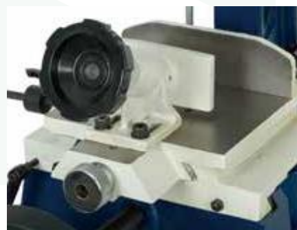
X-Y tengelyen állítható csúszóasztal, pontos beállíthatóság
